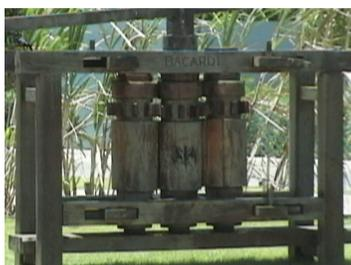
Es una máquina o molino con tres rodillos estriados (mazas) por los cuales se pasa la caña para hacer la extracción del jugo y separarlo del bagazo, en el pasado se usaba como fuerza motriz los animales (bueyes).
